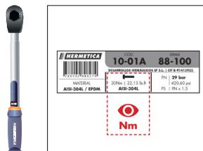
4.5.2. Apretar los tornillos de uno de los cierres hasta llegar al par indicado por la llave. Ajustar los tornillos del cierre opuesto alcanzando el par indicado. Evita angularidad.
